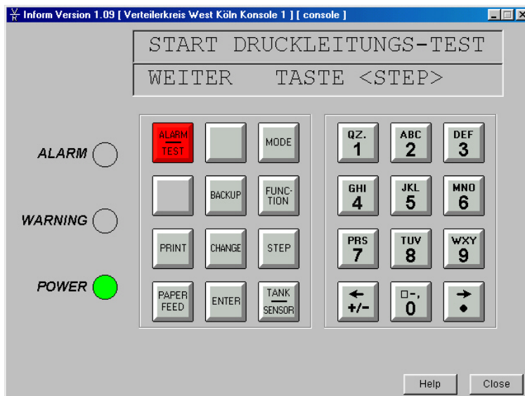
Abb. 2: Anzeige Start Druckleitungslecktest.
