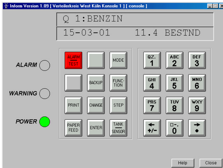
Abb. 8: Anzeige 11.4 Liter Test, 1. Kraftstoffleitung
