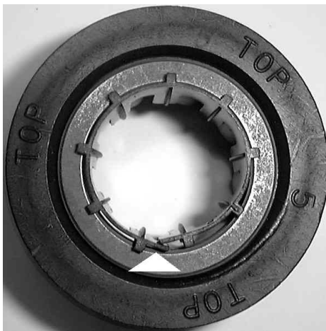
Abb. 11: Produktschwimmer mit nicht korrekt angebrachten Befestigungsclips
