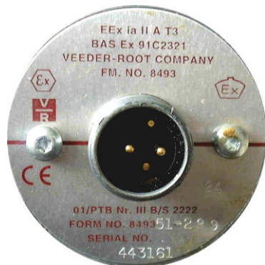
Abb. 1: Das Sondentypenschild mit der Teilenummer (FORM NO.)
