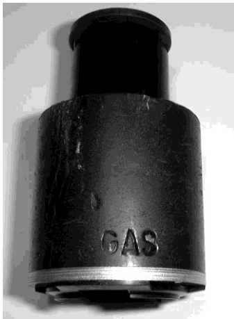
Abb. 8: Der Wasserschwimmer mit Prägung (hier GAS für Ottokraftstoffe)
