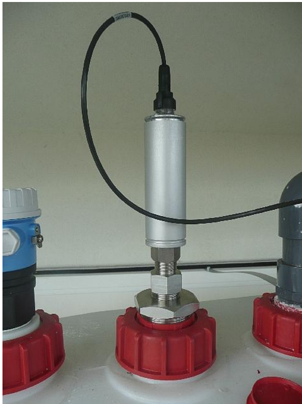
Abb. 1: herkömmliche Installation der Sonde
