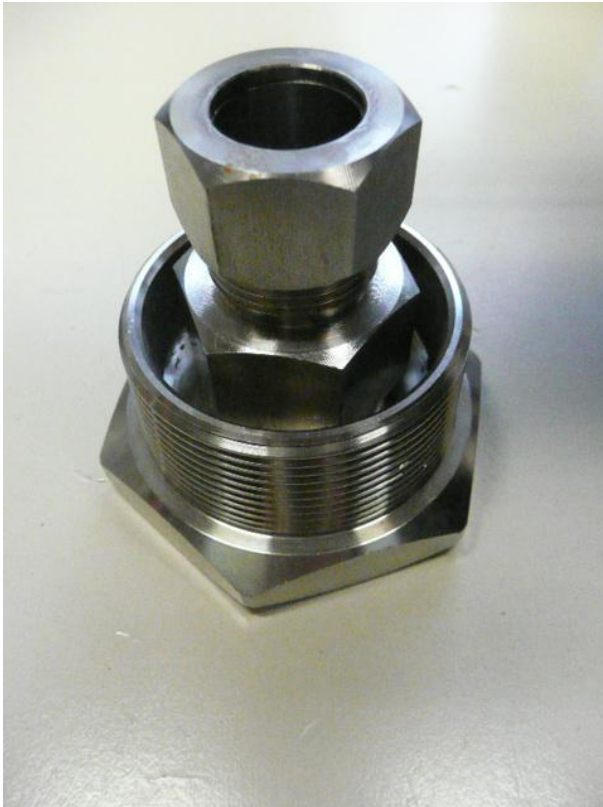
Abb. 3: Installation Sondenverschraubung „von unten“
