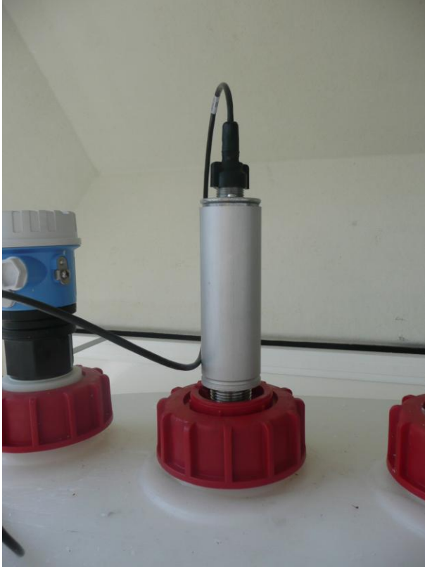
Abb. 5: Sonde mit verdrehter Verschraubung im Tank
